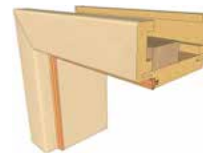
Řez obložkovou zárubní protipožární DPO
