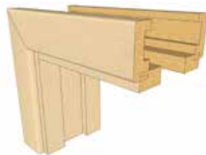
Řez obložkovou zárubní pro stavební pouzdra síla zdi od 10 cm, límce 6 cm
