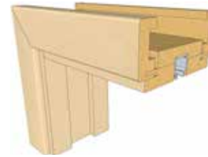
Řez obložkovou zárubní sklapovací síla zdi od 10 cm, límce 6 cm
